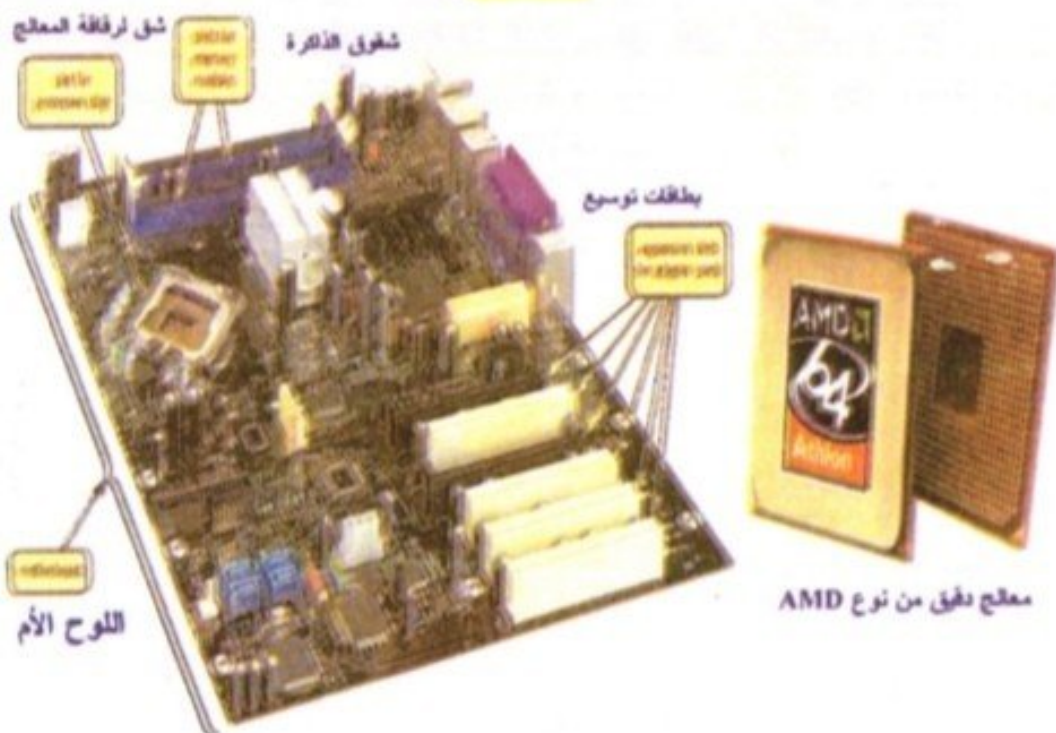
الشكل (2-24) الأجزاء الداخلية لوحدة النظام ، مع منظر علوي وجانبي لوح الأم
