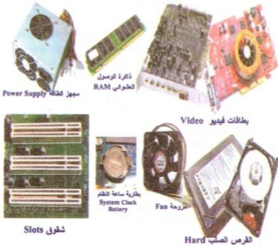
الشكل (2-25) أجزاء داخلية من وحدة النظام كلاً على انفراد
