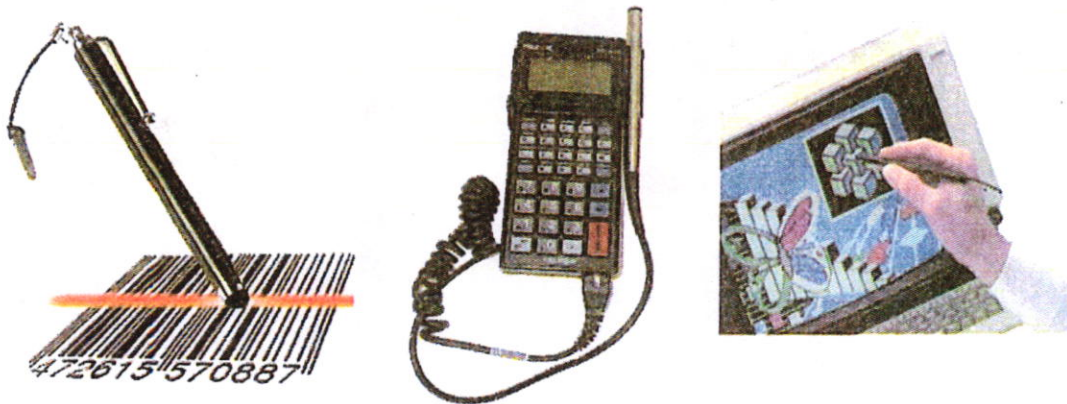
الشكل (14-2) أشكال من القلم الضوئي واستخداماته
